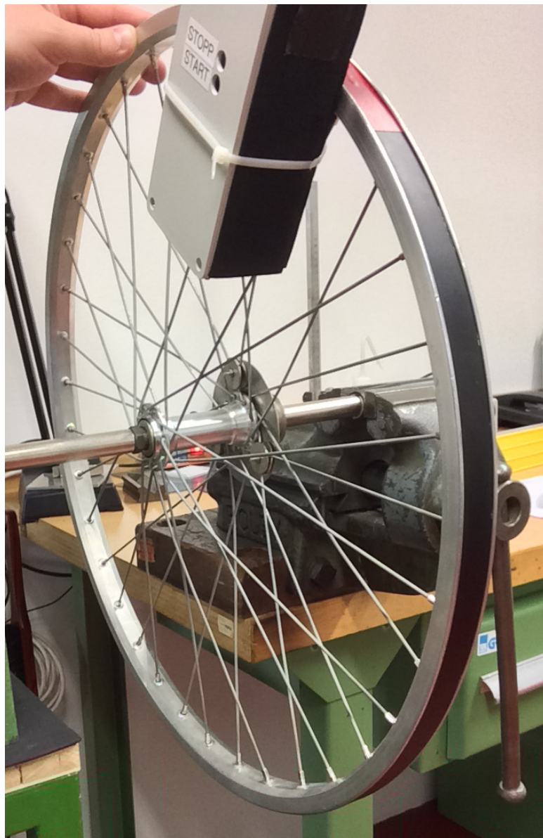
Abbildung 67: Versuchsanordnung zur Messung der Zentripetalbeschleunigung bei vertikaler Rotation mit einer ausgebauten Fahrradfelge. Die Sensorbox wird möglichst weit außen so fixiert, dass eine der Achsen des Sensors in radialer Richtung liegt. Durch Antreiben der Felge mit einem Motor konnte eine konstante Zentripetalbeschleunigung erreicht werden. Diese Messung kann jedoch auch sehr gut genutzt werden, um Formel 9 quantitativ zu überprüfen.
