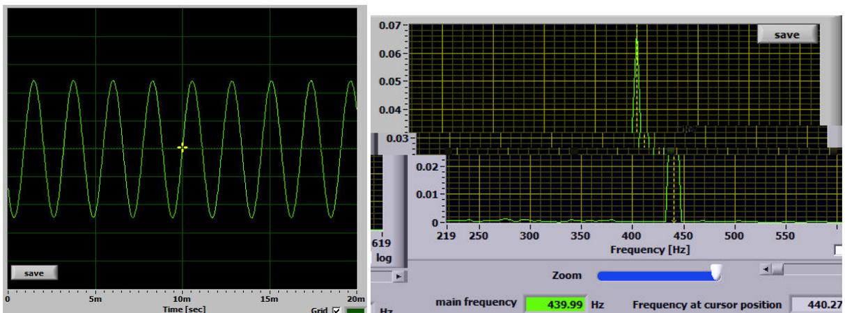
Das mit dem Tongenerator erzeugte Sinussignal zeigt einen deutlich schmalen Peak.
