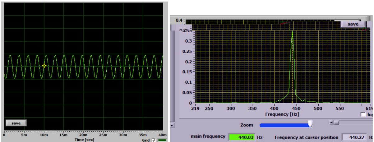
Die verwendete Stimmgabel weist eine harmonische Schwingung mit einer Frequenz von 440 Hz auf. Die Frequenzanalyse zeigt nur einen sehr großen Peak (bei 440 Hz).
