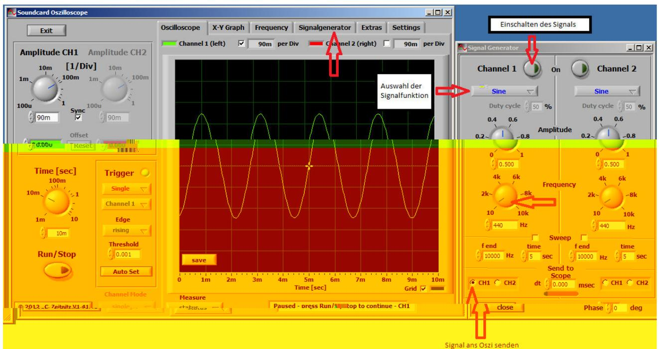
Für die Erzeugung eines Sinussignals muss zunächst der Signalgenerator geöffnet werden (Tab „Signalgenerator“, dann „in eigenem Fenster anzeigen“). Damit das erzeugte Signal auch im Oszi angezeigt wird, sollte im Signalgenerator „CH1“ ausgewählt werden. Die Frequenz und die Signalfunktion können über die jeweiligen Schaltflächen eingestellt werden.
